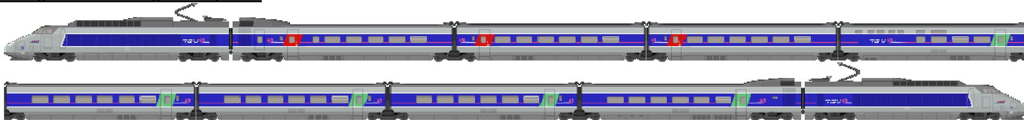
Rames "Ligne de cœur" sigle CFF (rames 112 et 114) : MOTRICE+R1 1cl+R2 1cl+R3 1cl+R4 bar+R5 2cl+R6 2cl+R7 2cl+R8 2cl+MOTRICE
