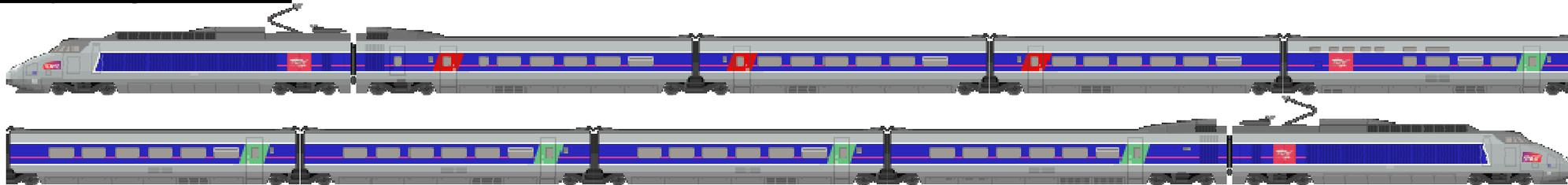
Rames "Lyria" avec sigle CFF (rames 112 et 114) : MOTRICE+R1 1cl+R2 1cl+R3 1cl+R4 bar+R5 2cl+R6 2cl+R7 2cl+R8 2cl+MOTRICE
