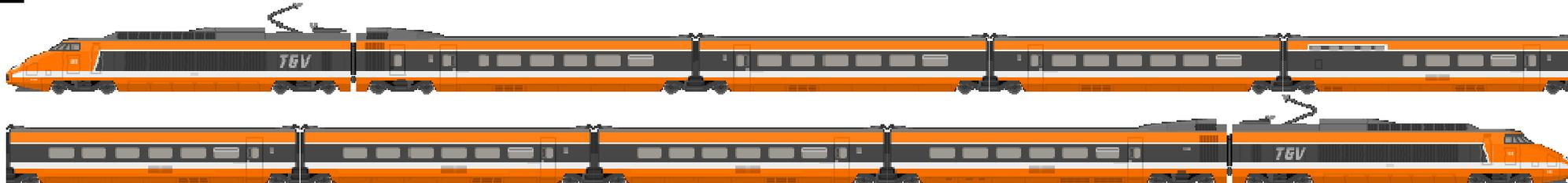
Origine avec bar modifié : MOTRICE+R1 1cl+R2 1cl+R3 1cl+R4 bar+R5 2cl+R6 2cl+R7 2cl+R8 2cl+MOTRICE
